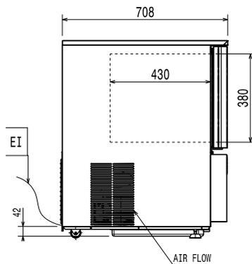
EI = Conexión eléctrica (energía)
